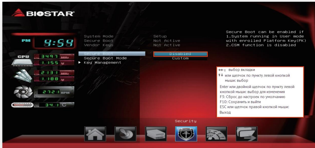
Рисунок 62 — Настройка SecureBoot (отключение)
